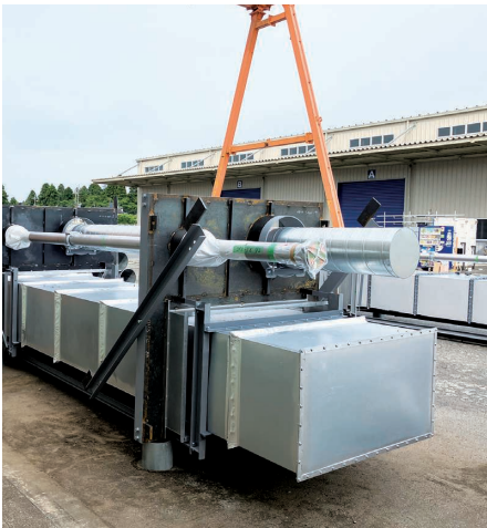
工場でのライザー工法用ユニット製作の様子
