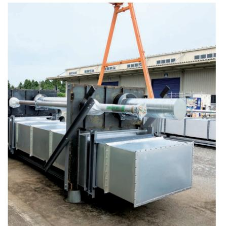
工場でのライザー工法用ユニット製作の様子
